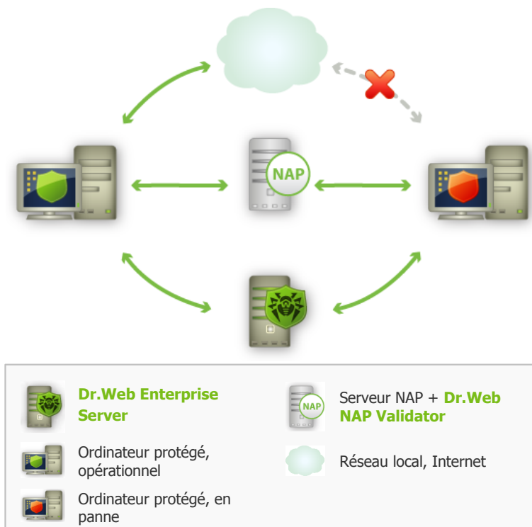
Figure 10-2. Schéma du réseau antivirus en cas d'utilisation de NAP
