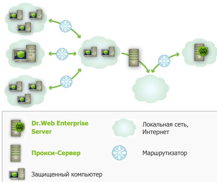
Рисунок 10-1. Схема антивирусной сети при использовании Прокси-сервера
